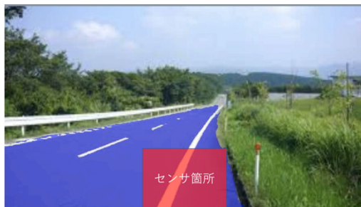
図4 道路部分のマスクと ON-OFF 制御のセンサ箇所
