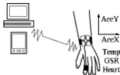
図 1: LifeMinder®の構成。X 軸加速度(AccX)、Y 軸加速度(AccY)、皮膚温度(Temp)、皮膚電気反射(GSR)、脈波(Heart)が計測可能。Bluetooth 通信により PDA 等でデータが送受信可能。
